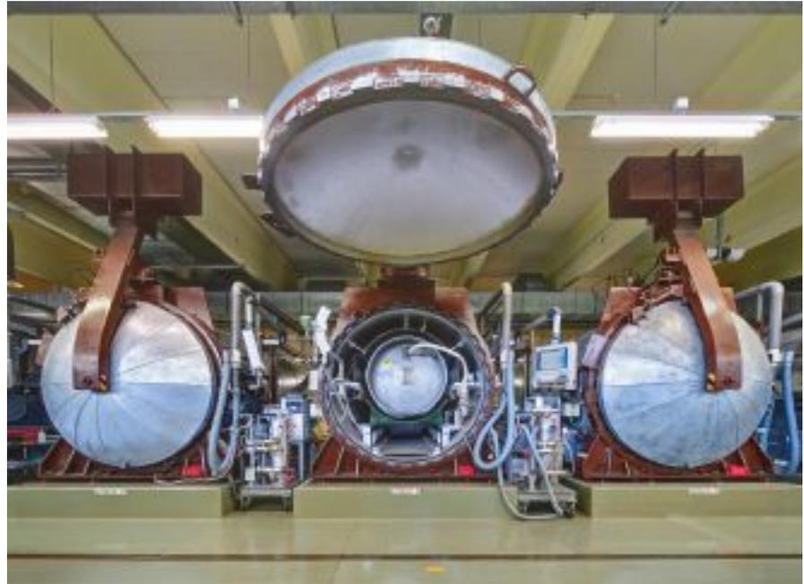
Abbildung 3: Geöffneter Autoklavendeckel mit angeschlossenem  $UF_6$ -Behälter
